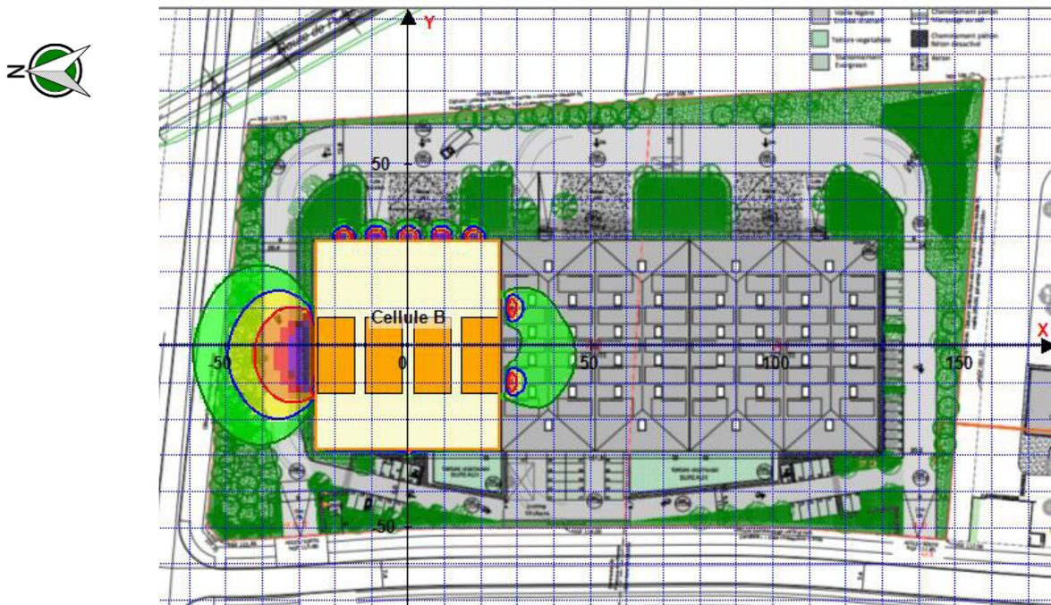
Figure 4 : Représentation graphique de flux thermiques du scénario 3
