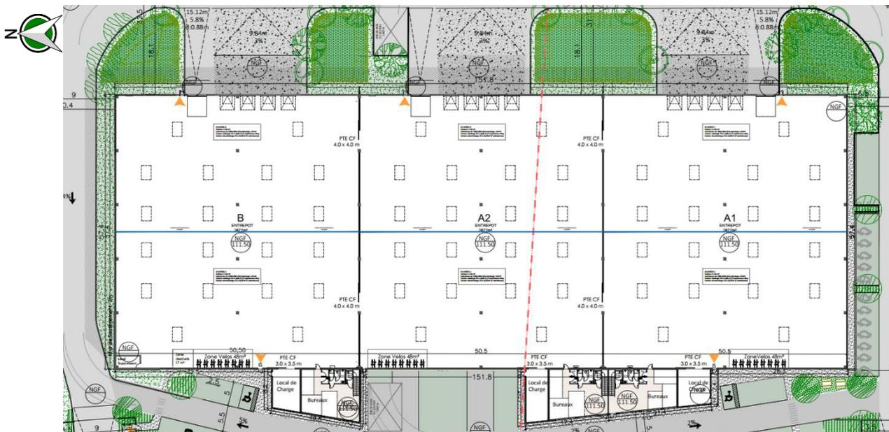
Figure 2 : Surface de désenfumage au niveau de la couverture de l'entrepôt
